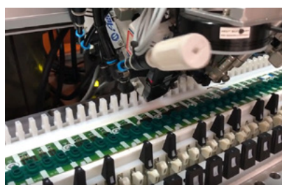
鍵盤の自動組み立てライン
